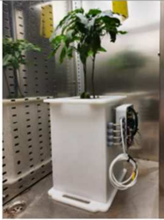
Fig.4: Laboratory Proof-of-Concept EIT unit
